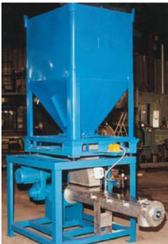
Typowe zastosowanie przemysłowe: rozładowanie kosza przy pomocy wibratora doczepnego.
