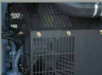
Zabezpieczenia ruchomych części
